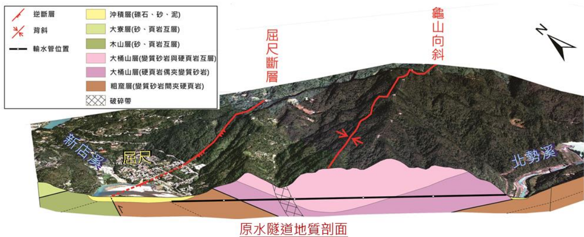
圖 3-7 原水隧道地質剖面圖
