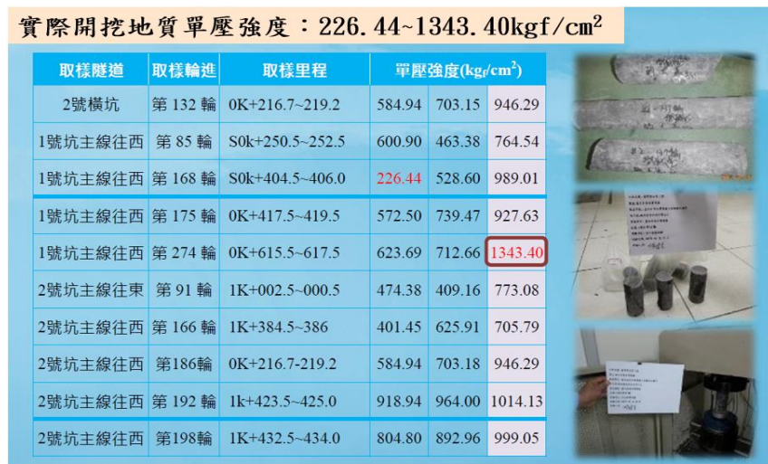
圖 3-3 設計階段岩石單壓強度調查結果
