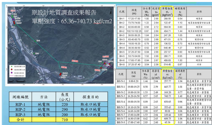
圖 3-3 設計階段岩石單壓強度調查結果
