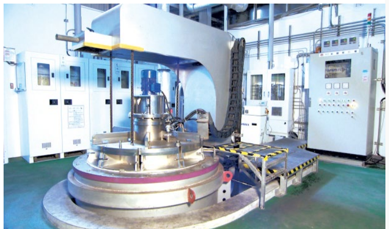
■ 金屬中心在經濟部技術司支持下，成功開發「不鏽鋼耐蝕暨表面硬化系統設備」，不鏽鋼可同時具備高硬度和高耐腐蝕特性。
