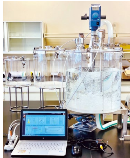
食品所開發植物性飲品製程調控平台，供業者快速評估量產參數設計，提升製程效率與產品品質。
