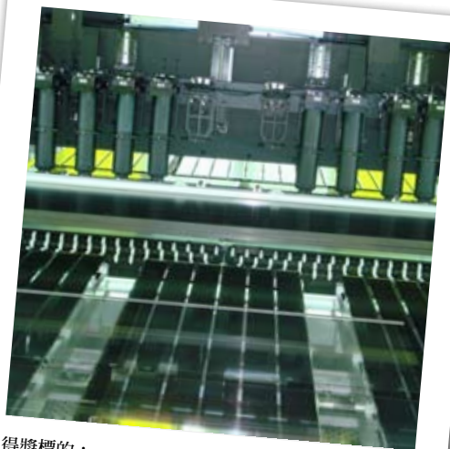
得獎標的： 可檢測 1\mu\text{m} 瑕疵高階自動光學檢測技術
