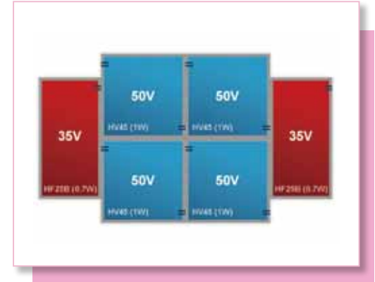
》世界最高效率216 lm/W之暖白光高壓晶片組合
