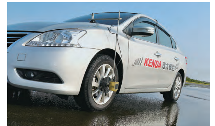
透過輪胎花紋設計調整，進行滑行噪音與濕抓地力測試。
