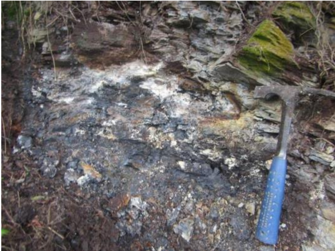
圖4-10 基地北側左岸露頭西緣斷層帶。
