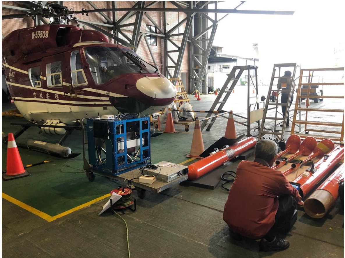
圖 7 直升機裝載高精度重力儀(直升機旁藍色設備)，結合磁力拖鳥(圖右橘色設備)進行空中重力磁力聯合調查
