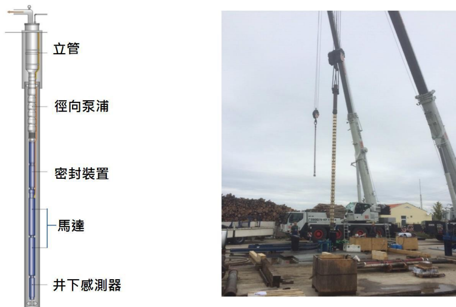
圖 8 井下電泵結構(修自 Geothermie-Heizkraftwerk Sauerlach, SWM, 2017)
