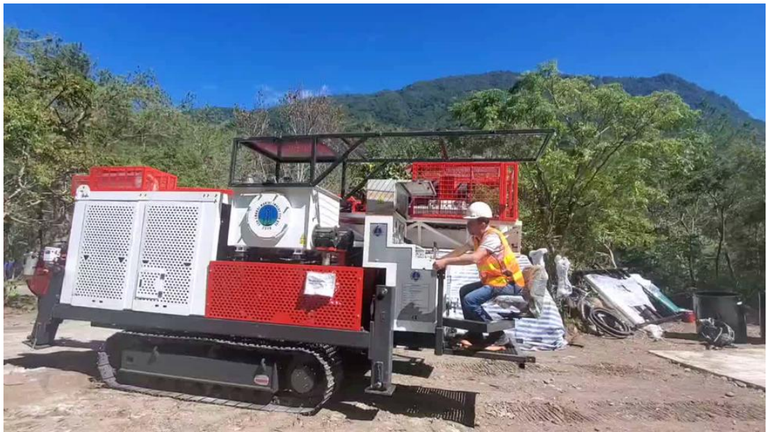
圖 8 履帶式小孔徑取芯鑽機，因應探勘初期之調查。(圖片來源：國外團隊協助臺東探勘場址)
