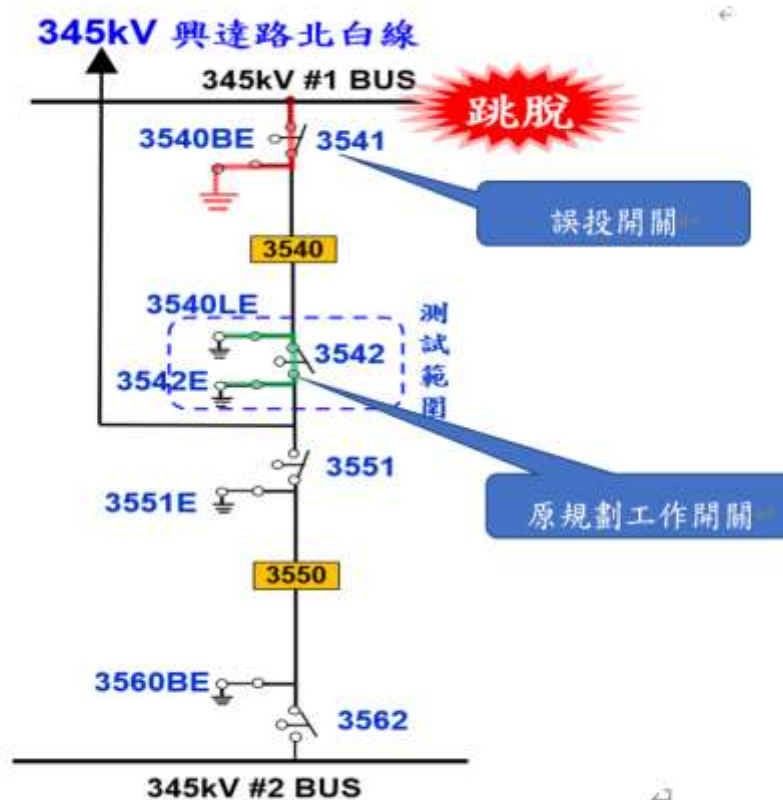
圖 1-3 3542 隔離開關接觸電阻量測路徑圖
