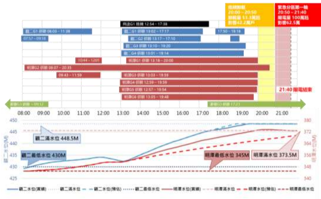
圖 2-8 517 停電事件-機組併聯時序與觀二、明潭下池水位變化
