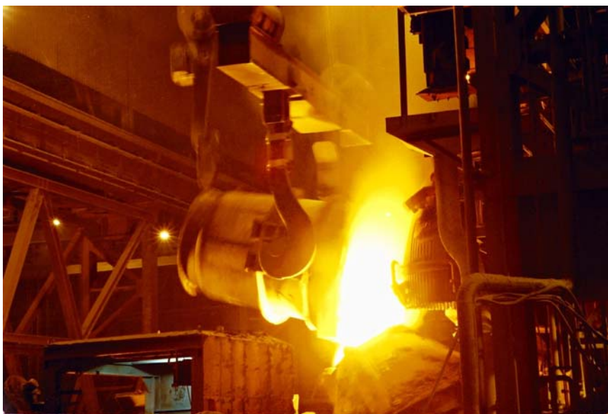
■ 電爐鋼液倒入 AOD 轉爐精煉之受鋼作業
