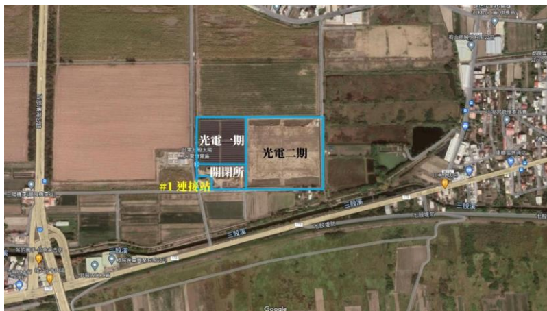
圖 a 七股 E/S 工程預定地光電用途（光電、開閉所及連接站）配置
