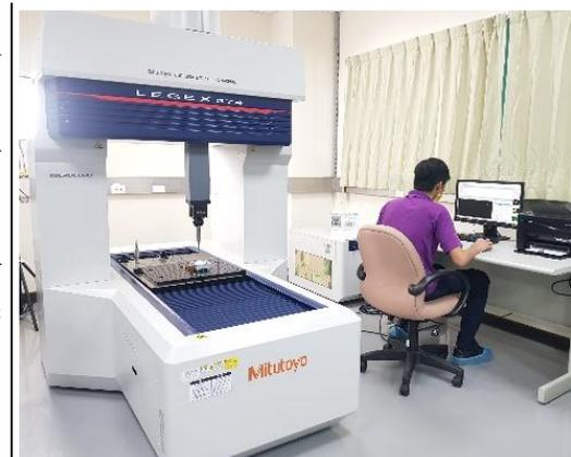
圖說：參訓學員於精密量測課程中，操作三次元量測儀。
