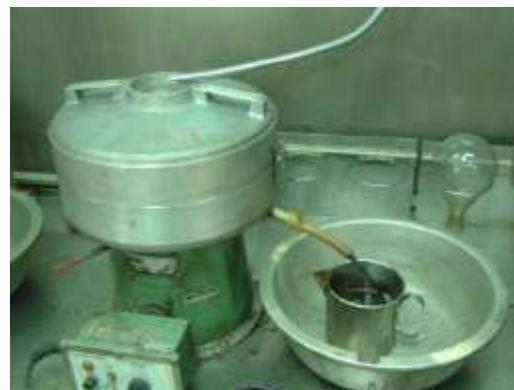
c. 將試驗鉢至入離心機中分離出瀝青溶液
