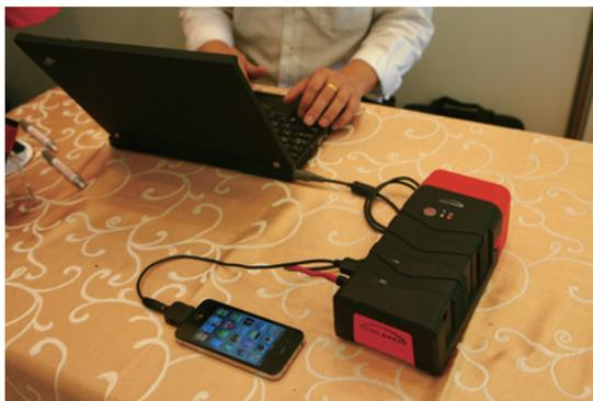
> 可攜式固態化學氫電源足夠供給5~7支手機或手提電腦3~4小時的電力。
