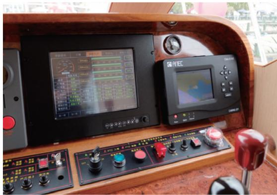
► 船用智慧型裝備－複合動力監控系統，結合IT應用技術作為船用裝備發展的主要方向，已安裝於日月潭之複合動力觀光船。
