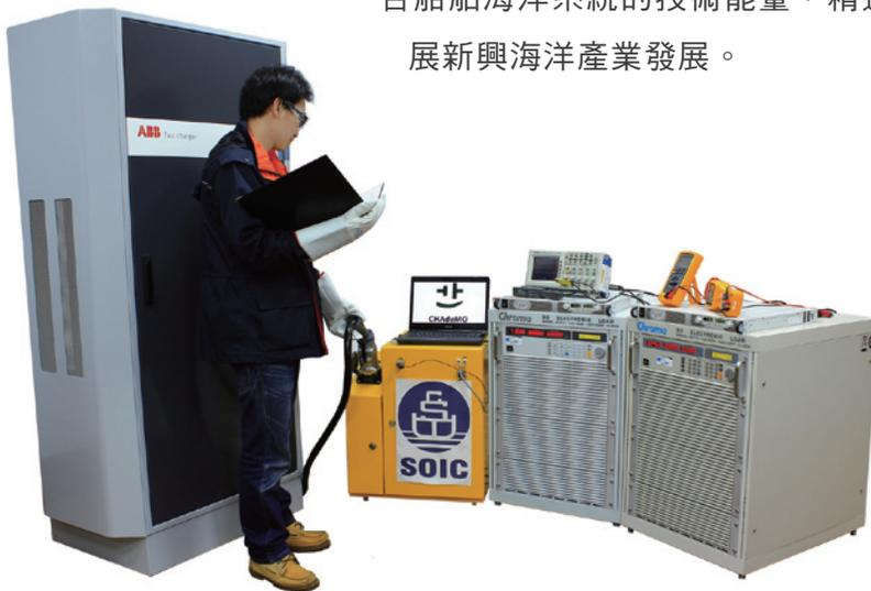
➢ 綠能動力技術－開發之直流快速充電控制器，為國內第一套符合 CHAdeMO規格之直流快速充電控制器。
