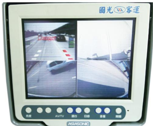
左上方分割圖為車輛向右偏移車道（紅線處），車輛駕駛警示系統主動提出Danger語音警示，防範事故的發生。
