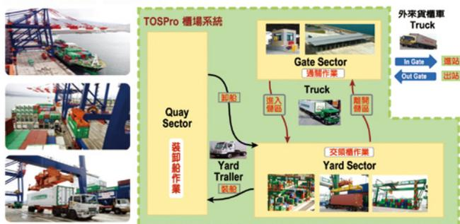
外部貨櫃車作業（圖中紅色路線）係指由外部貨櫃車從車輛駛進港區通關作業區(Gate Sector)，領取儲位報到卡開始，此時貨櫃車則已進入ZigBee無線感測網路的全面監控中，並由台北港控制室人員指派前往儲區，執行交櫃或領櫃任務。作業完成後，出港前交回報到卡，取得工作明細，以確認完成所有任務。
