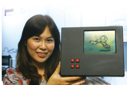
「膽固醇液晶螢幕」：主動式驅動的5吋膽固醇
