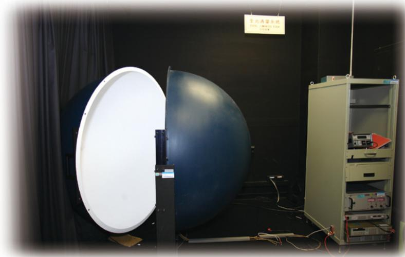
LED全光通量量測系統，單位為流明(lm)，光通量係由一光源所發射並被人眼感之的所有輻射能。由於LED發光空間分布不均，使用大直徑的積分球，將LED置於球體中心以量測LED全光通量。
