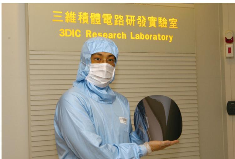
工研院3DIC實驗室將晶圓磨薄後，厚度僅有 $25\mu\text{m}$ ，只有一根頭髮厚度的 $1/4$ ，將4-10層的超薄晶圓堆疊後，立體堆疊片厚度小於 $1\text{mm}$ ，比傳統單一晶片的封裝厚度還薄。
