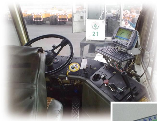
(左圖) 負責船邊到貨櫃儲放區的裝櫃、卸櫃作業的內部碼頭作業車，車上備有 7 吋螢幕的車載機，由控制室以最有效的方式來指派任務。
