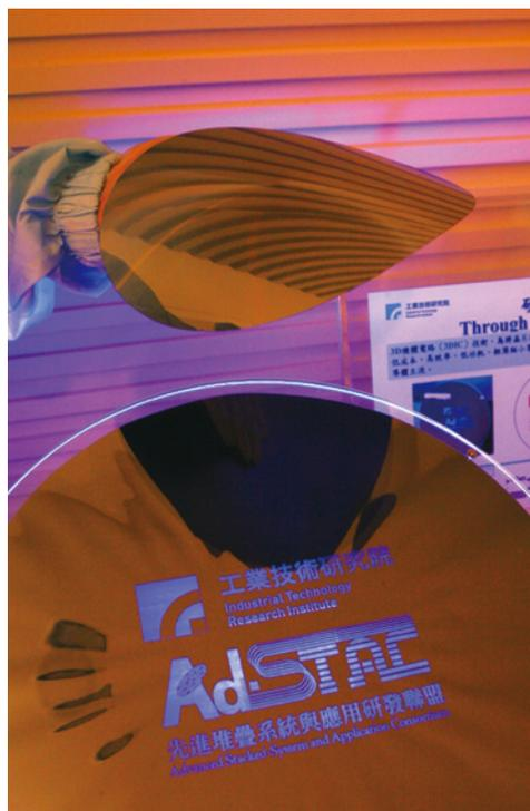
3DIC的矽基板穿孔技術如同在摩天大樓中建置高速電梯的通道，本技術可以將感測晶片、邏輯晶片、RF高頻晶片、記憶體等不同功能晶片，整合在一片微小型晶片中，被整合的晶片在經矽基板穿孔、堆疊、封裝後，單一厚度小於傳統晶片，晶片間訊號傳遞距離及速度將快速縮短。
