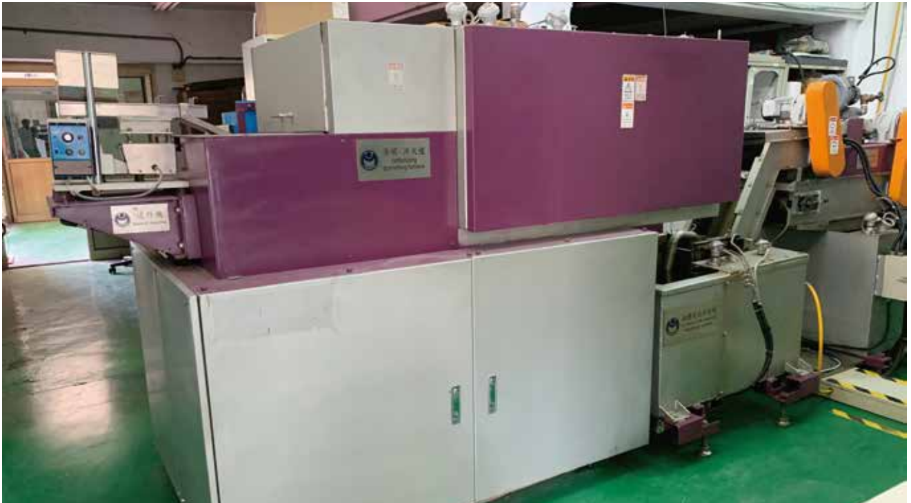
▲ 精微金屬零組件熱處理設備
