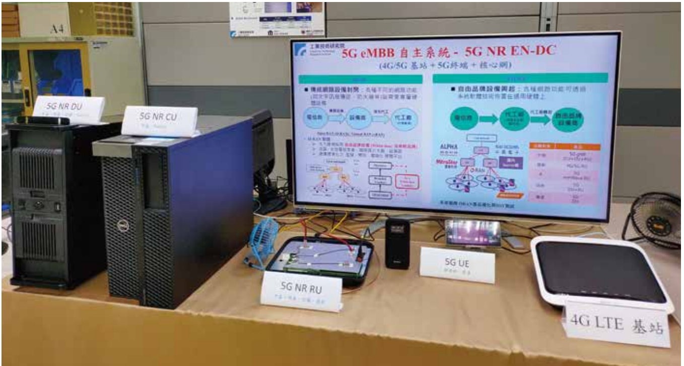
▲ 5G小基站符合O-RAN架構，提供自由品牌設備商在5G專網之基站解決方案
