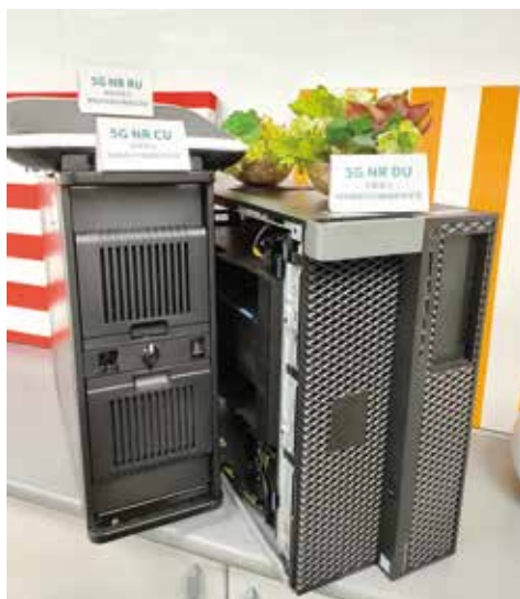
▲ 5G小基站元件包含CU (Central Unit)、DU (Distributed Unit) 跟RU (Radio Unit) 等三大元件
