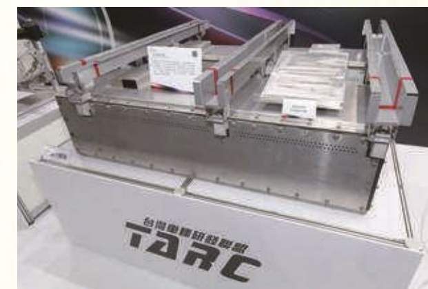
輕量化電池承載結構
